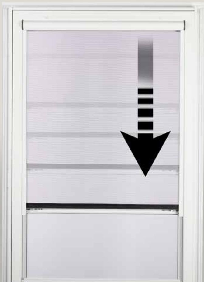
La moustiquaire rétractable à aération dissimulée est conçue afin de libérer la vue lorsque le châssis est fermé et de permettre l'aération lorsqu'il est ouvert. La moustiquaire logée dans une cartouche installée en usine dans la portion supérieure de la section vitrée se déroule du haut vers le bas lors de l'ouverture et de la fermeture du châssis ouvrant.
